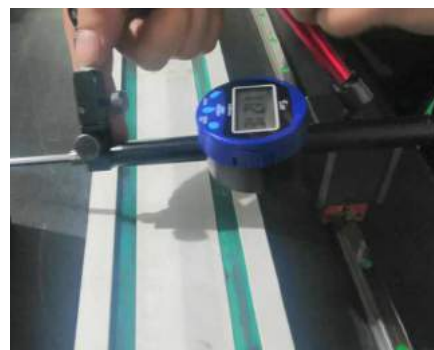
1、检测平行度/等高度 Detect parallelism / equal height
